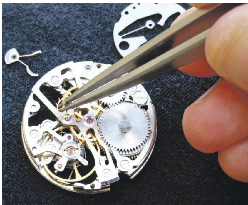
Uhrmacher bei der Regulierung eines mechanischen Uhrwerkes. (Foto: ZVG)
